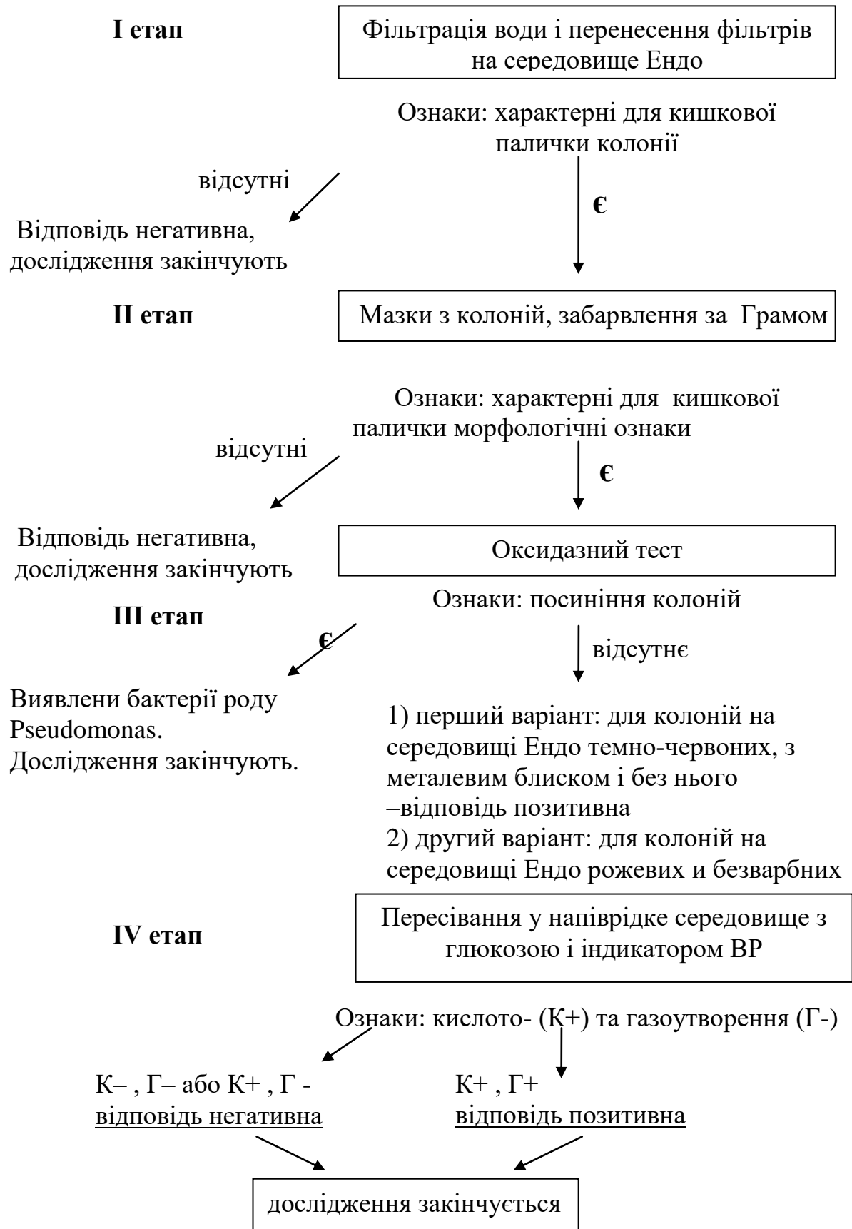
Рис. 42 – Хід дослідження води методом мембранних фільтрів
